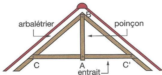
Dans la construction d'une charpente représentée ci-contre, le boulon fixant les arbalétriers au poinçon et celui fixant un arbalétrier à l'entrait sont distants de 3285 mm. Les boulons fixant l'entrait aux arbalétriers sont distants de 5134 mm.
